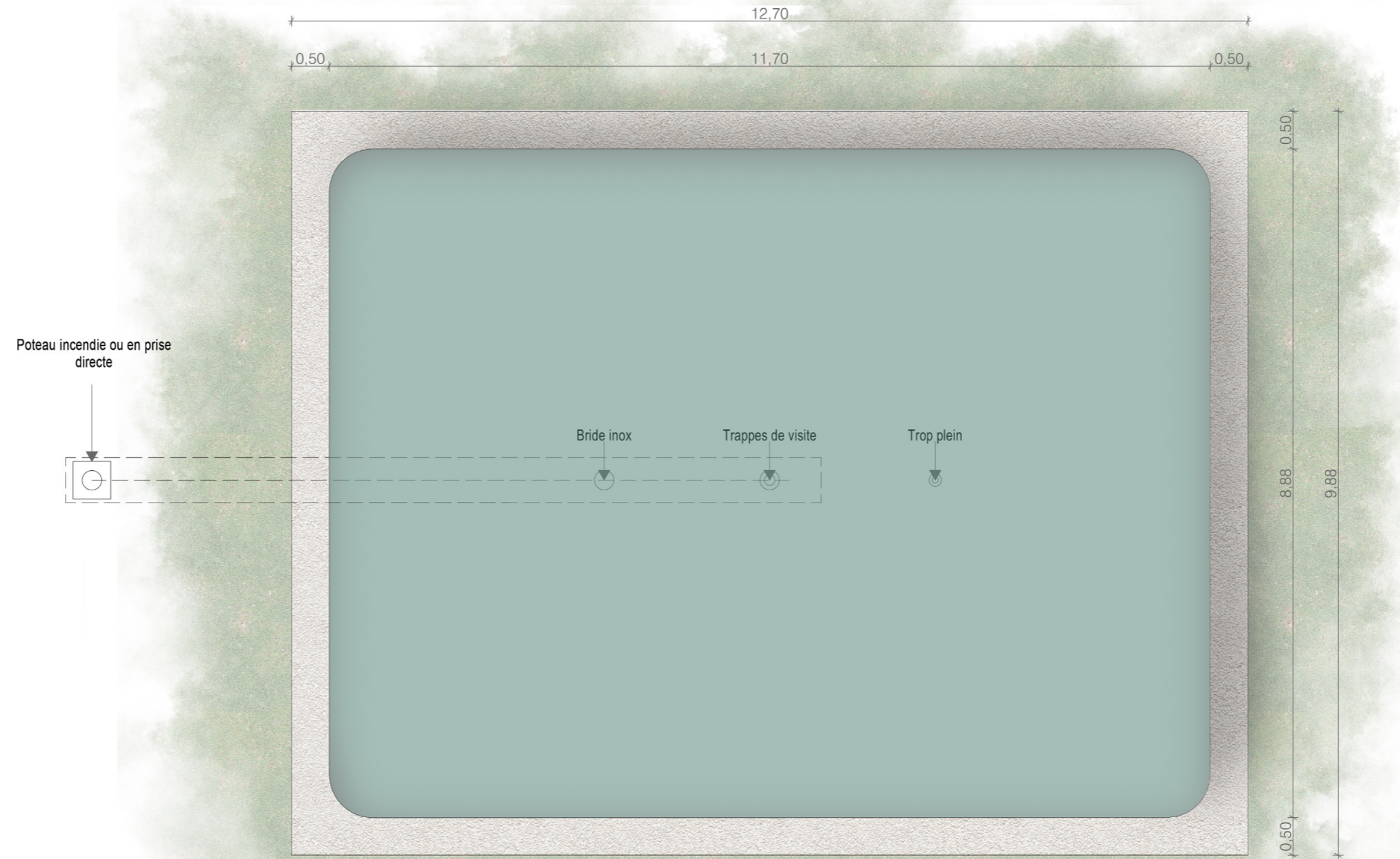
Citerne souple de 120m 3 Dimensions : Longueur 11.7m, largeur 8.88m, hauteur 1.6m
